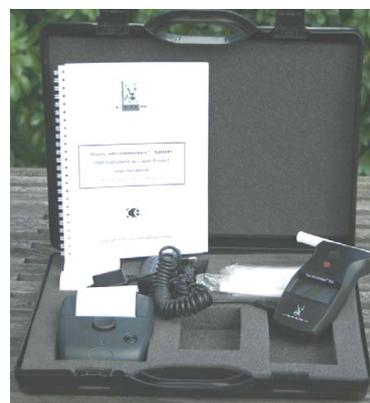
**ATTIVA** - il soggetto soffia nel boccaglio e lo strumento aspira automaticamente un campione di espirato per analizzarlo. Il micromotore lineare controllato via software, garantisce massima costanza di campionatura, quindi massima precisione e riproducibilità.
